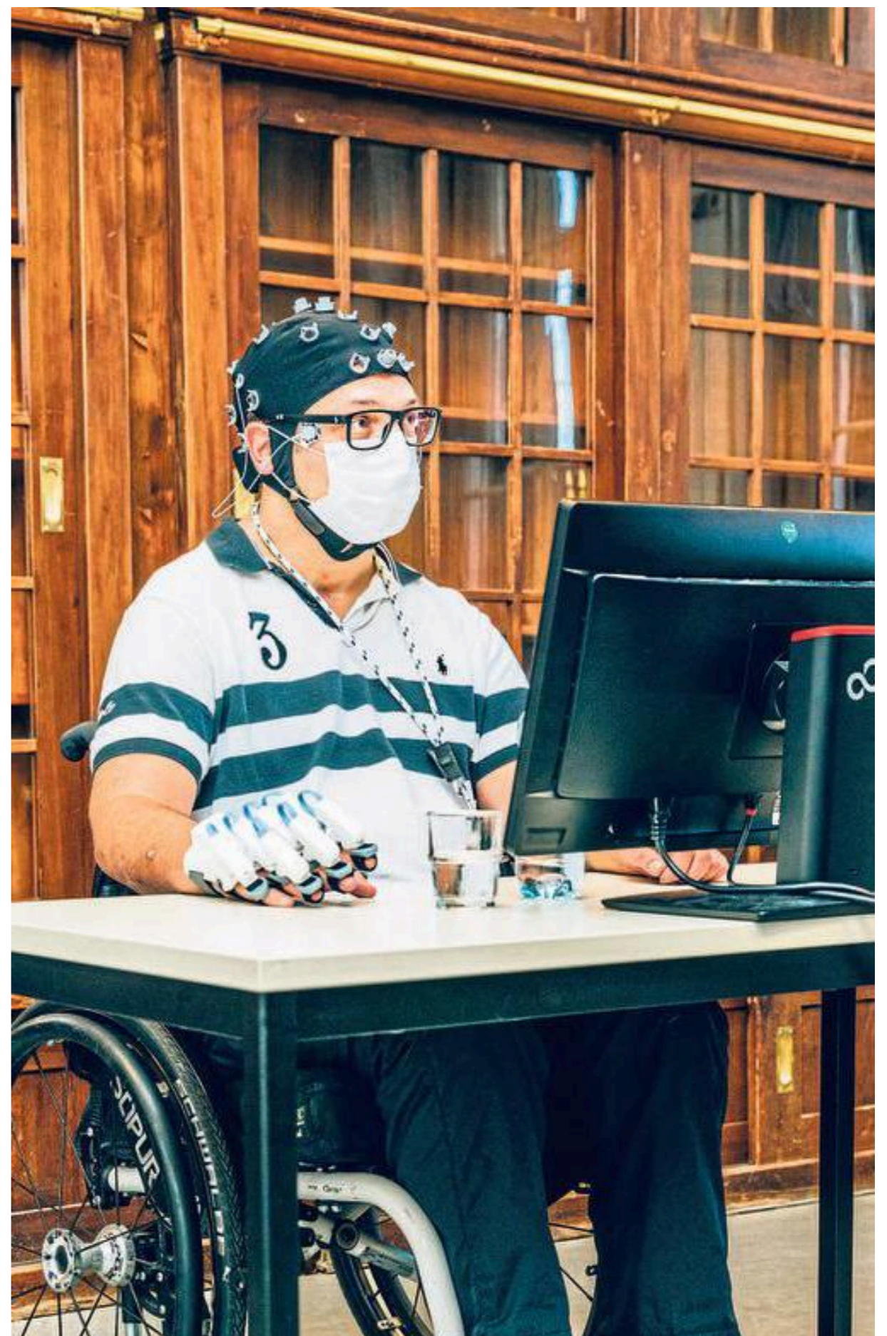
Sven Gräbe ist durch einen Unfall querschnittsgelähmt und kann seine Hände nicht mehr bewegen. Eine EEG-Haube auf seinem Kopf misst seine Hirnströme, während er sich vorstellt, seine Hand zu schließen. Diese Signale sendet die Haube an einen Rechner, der dann die Motoren in dem Exoskelett an seiner gelähmten Hand aktiviert. Damit soll Gräbe nur per Gedankenkraft wieder Objekte greifen können
