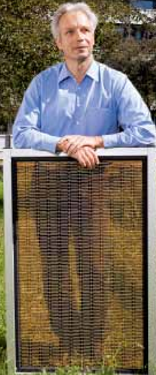
Andreas Hinsch, 50, mit seiner transparenten Farbstoffsolarzelle: Sie könnte in Fenster und Gebäudefassaden integriert werden
